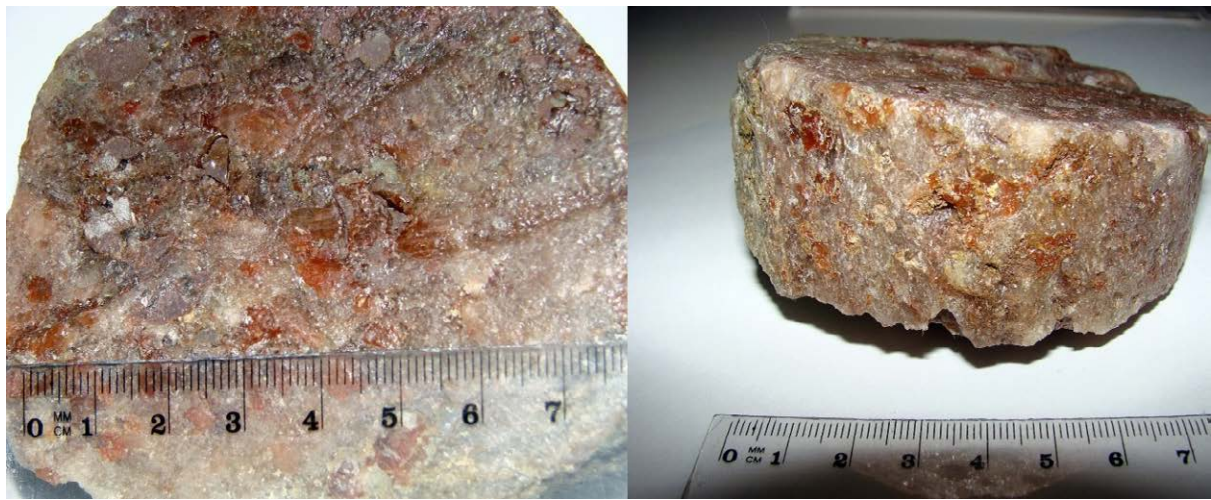
Ryc. 4. Zuber czerwony; głębokość 722 m, widok ogólny. Widoczne pomarańczowe ziarna halitu oraz brunatnoczerwone agregaty substancji ilastej. Próbką M-34/722.
