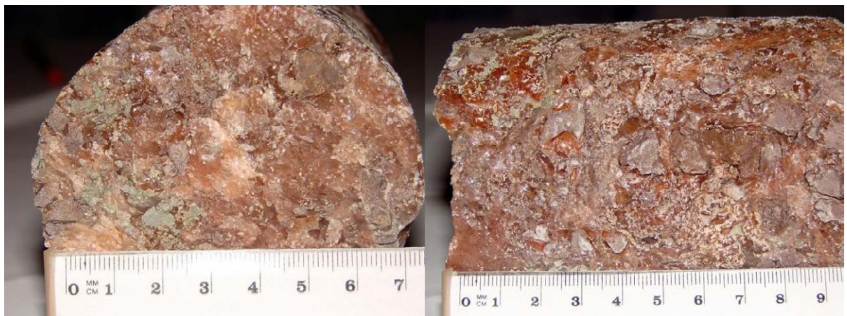
Ryc. 5. Zuber czerwony; głęb. 1000 m (widok ogólny). Widoczne pomarańczowe ziarna halitu oraz czerwobrunatne i szarozielone skupienia ilaste. Próbką M-34/1000.
