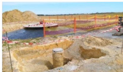
Ryc. 9. Odstonięta kolumna CMC przygotowana do badania dynamicznego
