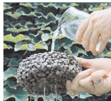
Fot. 5. Właściwości wodoprzepuszczalne porowatego betonu [26]
