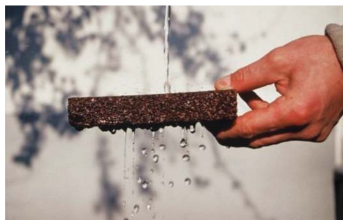
Fot. 3. Zdjęcie prezentuje właściwości wodoprzepuszczalne nawierzchni „Terraway” [14]
