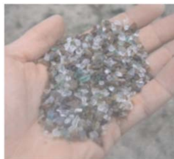
Fot. 7. Mieszanka recyklingowanego szkła [28]
