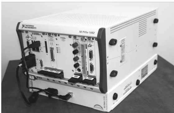
Rys.6 Modułowy system pomiarowy oparty na platformie PXI firmy National Instruments
