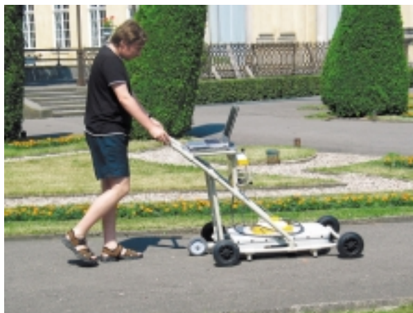
13. Ogród Wilanowski, badania za pomocą georadar. Fot. A. Gołębniak
