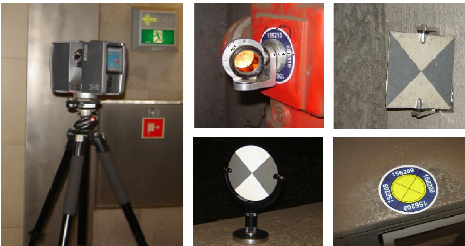
Rys. 3. Skaner laserowy Faro Focus 3D wraz z osprzętem pomiarowym
