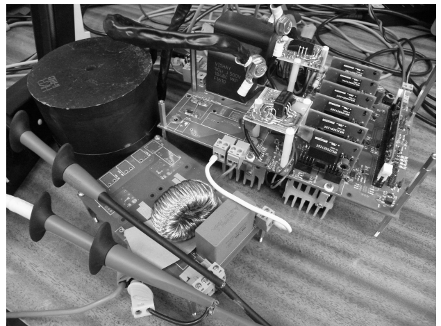
Rys. 5. Fotografia wykonanego laboratoryjnego falownika jednofazowego
