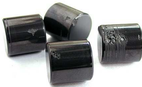
Rys. 2. Przykładowe formy wykruszeń zmęczeniowych wałków łożysk
