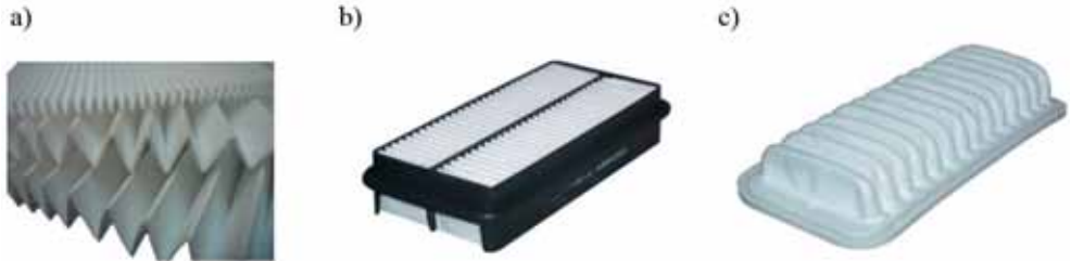
Rys. 6. Kształtowanie wkładu filtracyjnego z włóknin: a) plisowana taśma, b) wkład wykonany z plisowanej włókniny w sztywnej ramce, c) wkład panelowy w formie wypraski
