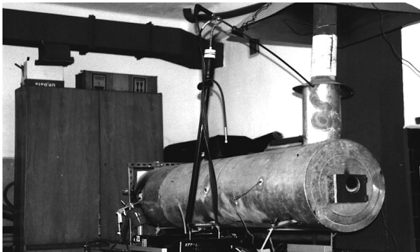
Rysunek 2 Stanowisko pomiarowe do spalania odpadów ciekłych w komorze z wykorzystaniem palnika gazowego — widok ogólny
