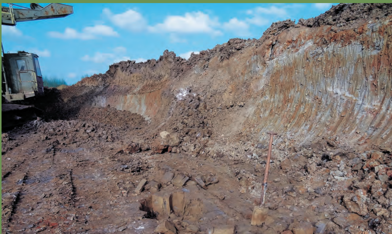
Ryc. 2. Iły mio-pleoceńskie widoczne w ścianie eksploatacyjnej wyrobiska zlokalizowanego w Budach Mszczonowskich. Obie fot. S. Stajszczyk Fig. 2. Mio-Pliocene clays exposed on the extraction wall of the Budy Mszczonowskie open-cut pit. Both photos by S. Stajszczyk
