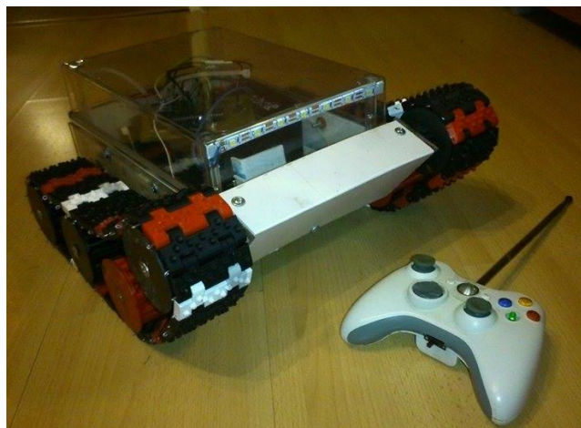
Rys. 13. Gąsienicowy eksplorator podwodny z pilotem - wykonanie rzeczywiste
