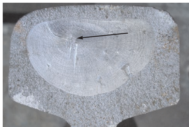
Rys. 4. Pęknięcie zmęczeniowe wewnątrz przełomu szyny A [fot. autor]
