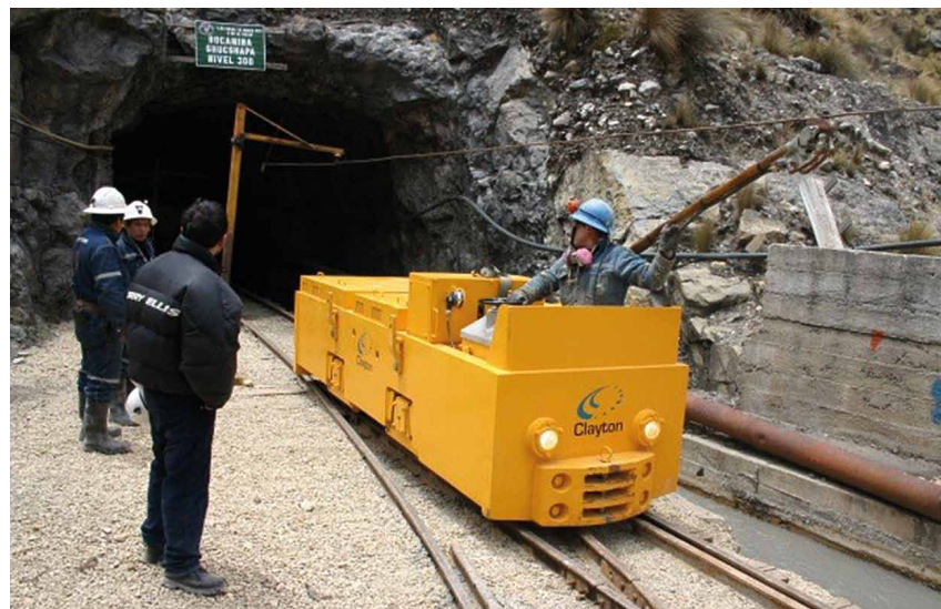
Rys. 2. Lokomotywa górnicza firmy Clayton [11]
