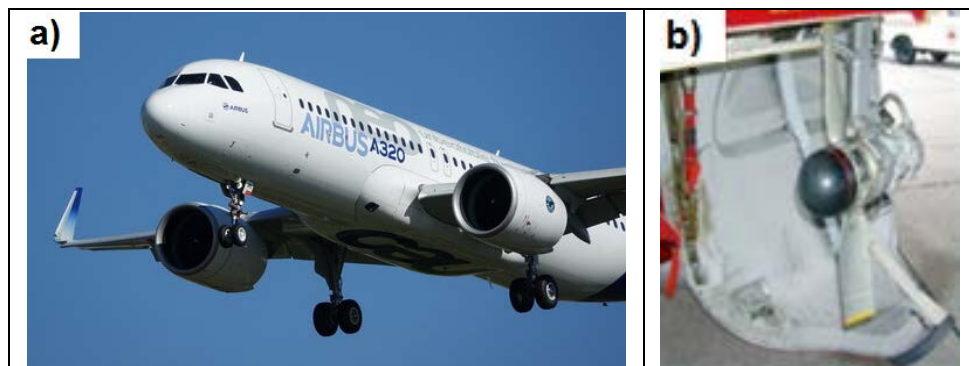
Rys. 8. Koncepcja prądnicy napędzanej pędem powietrza w czasie lotu przez osobne śmigło zamontowane na kadłubie statku powietrznego niepołączone ze strukturą silnika głównego: a) samolot Airbus A-320; b) generator awaryjny (napędzany strumieniem napływającego powietrza za pośrednictwem śmigła zamontowanego na wale prądnicy) samolotu Airbus A-320 [2]
