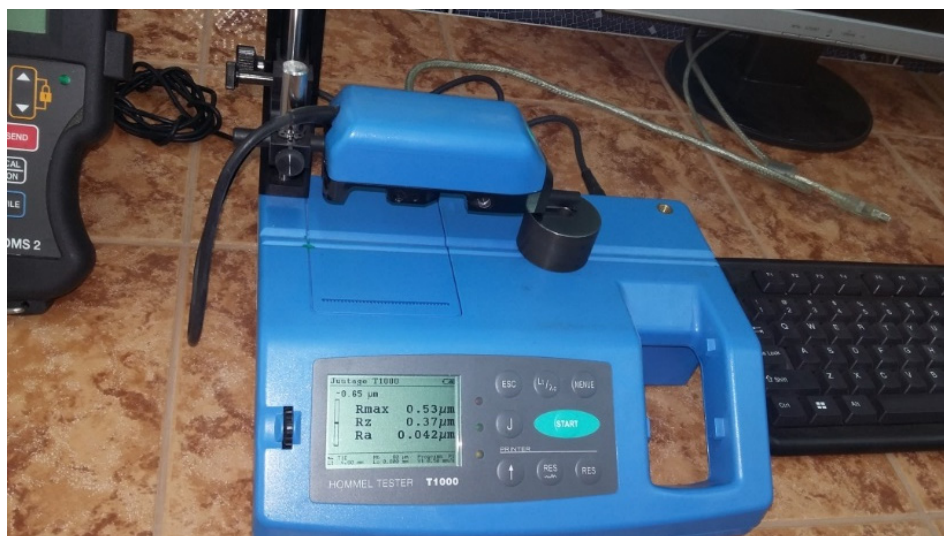
Rys. 4. Hommel Tester T 1000 służący do pomiaru chropowatości próbek
