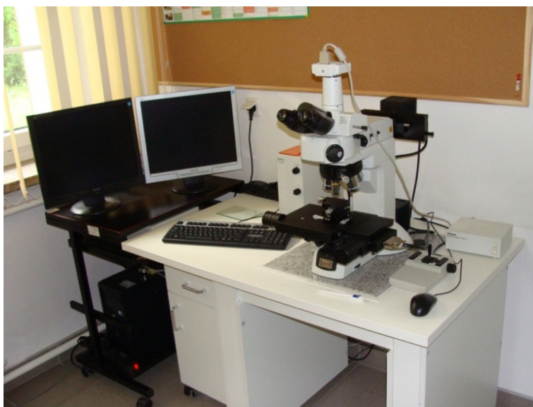
Rys. 5. Mikroskop optyczny Nikon ECLIPSE LV 100 wraz z osprzętem komputerowym
