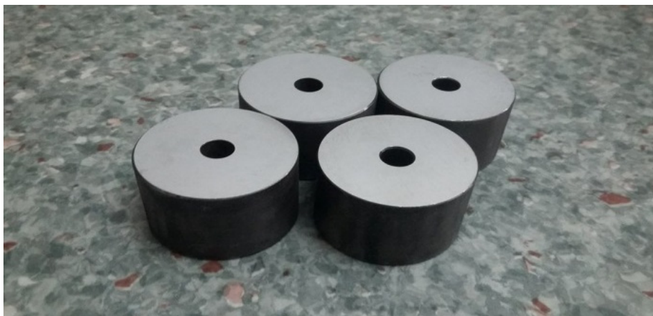
Rys. 3. Próbkki ze stali narzędziowej 145 Cr 6
