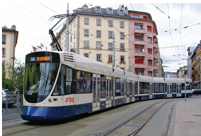
Obok Bombardierów, TPG Genewa eksploatuje także 44 siedmioczłonowe, dwukierunkowe tramwaje Stadler Tango Lemán, wyposażone w superkondensatory energii, umożliwiające odzysk energii hamowania, co wydatnie wpływa na obniżenie poboru energii elektrycznej podczas ruszania
