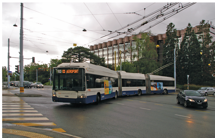
Chociaż TPG Genewa eksploatuje 10 dwuprzegubowych trolejbusów HESS lightTram o długości 24 m, ich eksploatacja nie wymagała budowy specjalnych dróg. Wszystkie trolejbusy, jak i 24-metrowe autobusy eksploatowane są w normalnym ruchu ulicznym
