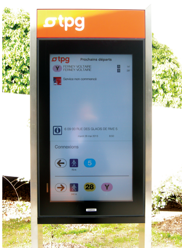
Na dużych węzłach przesiadkowych pojawiły się duże tablice LCD, nie tylko wyświetlające informacje o czasie odjazdu w czasie rzeczywistym, lecz również dodatkowe informacje o objazdach i zakłóceniach oraz kierunki i odległości dojścia do innych peronów węzła
