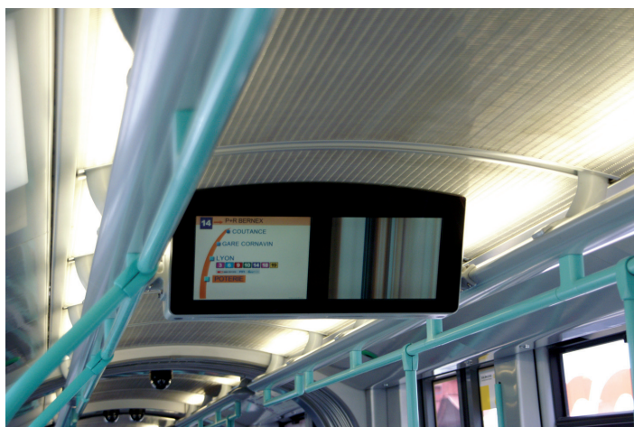
Każdy z nowych pojazdów jest wyposażony w nowoczesny system informacji pasażerskiej o podwójnych monitorach LCD o przekątnej 20 cali
