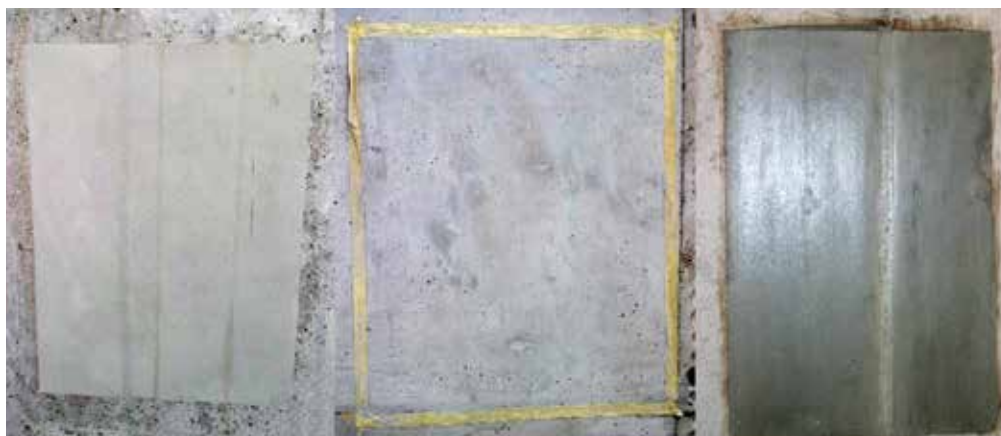
Fot. 3. Dobór masy naprawczej
