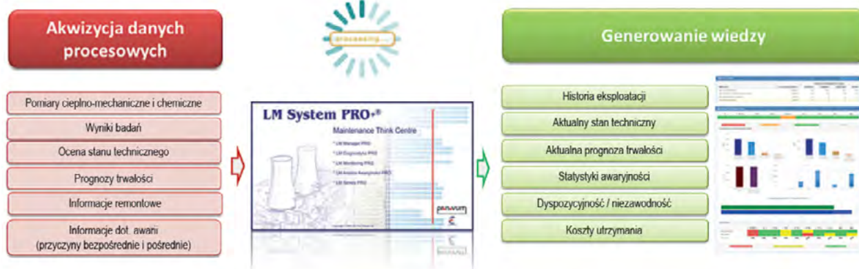
Rys. 3. Zdalna diagnostyka w formie wieloletniego serwisu LM Serwis PRO+ ® zapewniająca automatyczną aktualizację oceny stanu technicznego i prognozy trwałości, zrealizowana na Platformie LM System PRO+ ®
