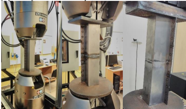
Rys. 4. Stanowisko badawcze do ściskania z modelem niespawanym, spawanym i spawanym z oszlifowanym licem spoiny.
