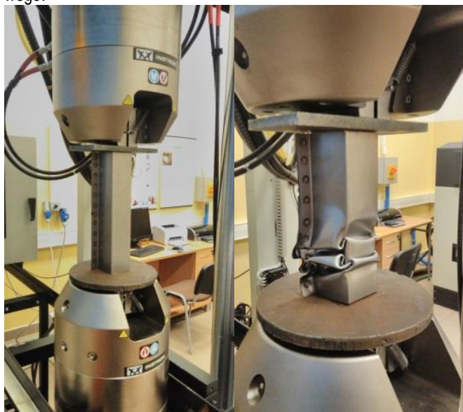
Rys. 1. Stanowisko badawcze do ściskania z modelem przed i po próbie.
