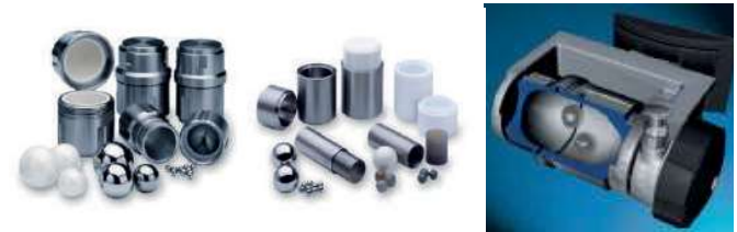
Rys. 5. Części mielące i schemat działania młynków kulowych []
