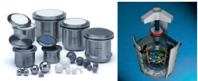
Rys. 6. Części mielące i schemat działania młynków planetarno-kulowych []
