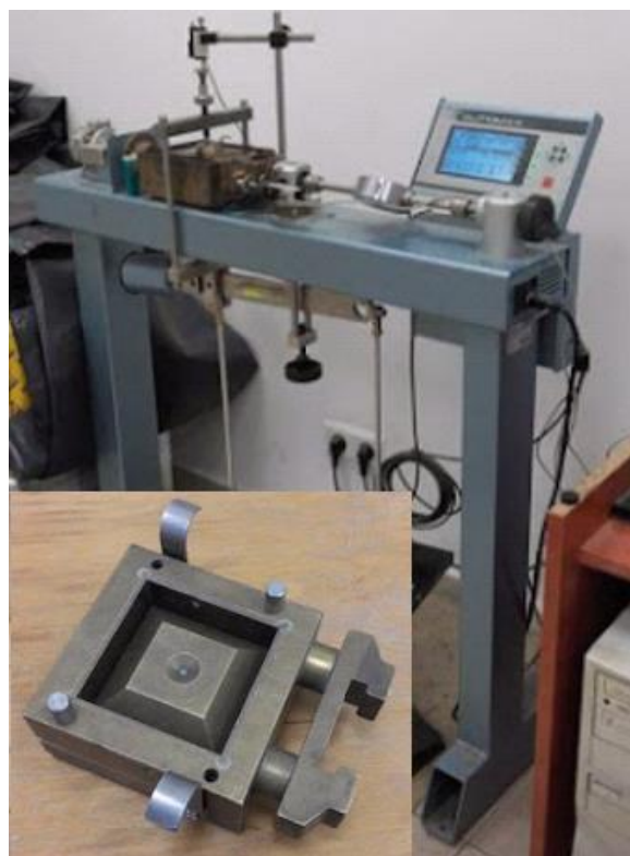
Rys. 3. Aparat skrzynekowy Katedry Współdziałania Budowli z Podłożem oraz skrzynka do badania
