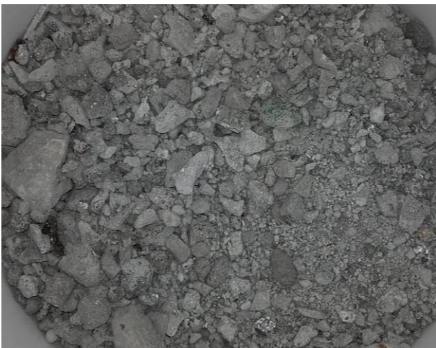
Rys. 1. Próbkę gruntu antropogenicznego poddana badaniom techniczno-wytrzymałościowym.
