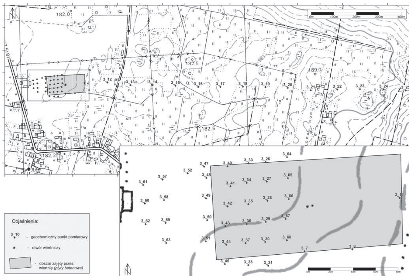
Rys. 3. Lokalizacja punktów poboru próbek gazu glebowego (III i IV etap badań – po zakończeniu szczelinowania hydraulicznego w otworze)
