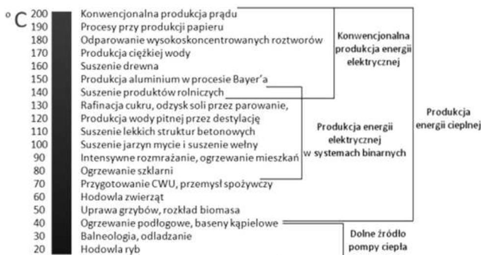
Rys. 1. Możliwości wykorzystania energii geotermalnej w zależności od temperatury cieczy geotermalnej (wg Lindal 1973)
