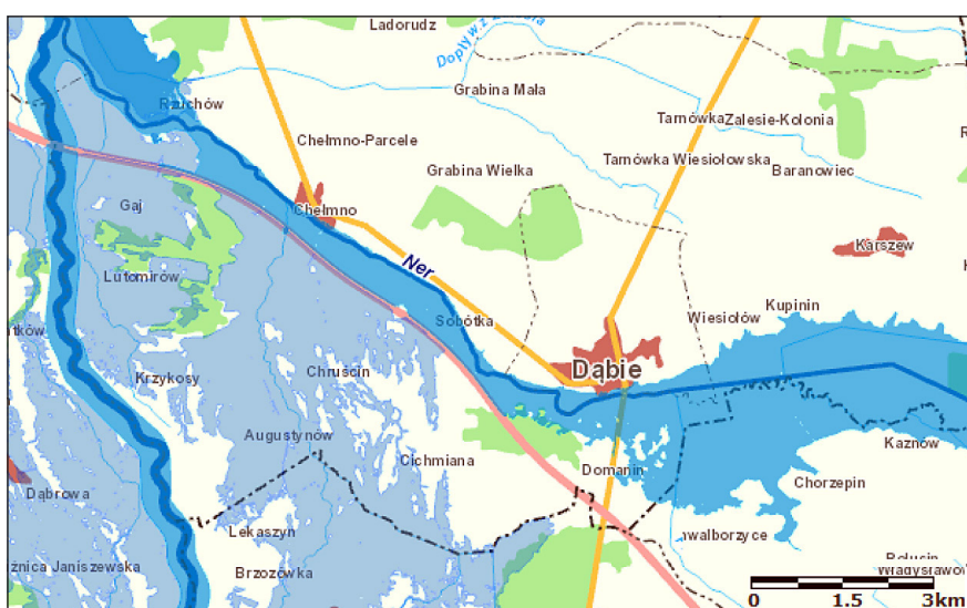
Rys. 1. Zasięg stref zagrożenia powodziowego wzdłuż analizowanego odcinka rzeki Ner przy prawdopodobieństwie wystąpienia powodzi p = 0,2\% ( http://mapy.isok.gov.pl/imap )
