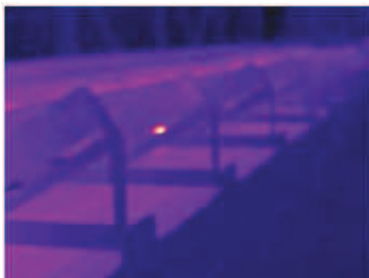
Rys. 14. Symulacja grzania punktowego pod taśmą przenośnika oraz wykres zależności widzianej temperatury od odległości dla trzech różnych kamer IR (MRSŁ [14])
