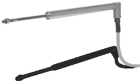
Rys. 4. Przetwornik drogi 1-WA/200MM, przed zamontowaniem na stanowisku badawczym
