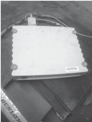
Rys. 3. Wzmacniacz pomiarowy HBM SPIDER8 przygotowany do badań
