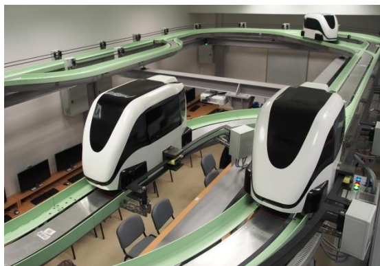
Rys. 3. Model fizyczny pojazdu PRT na stanowisku laboratoryjnym
