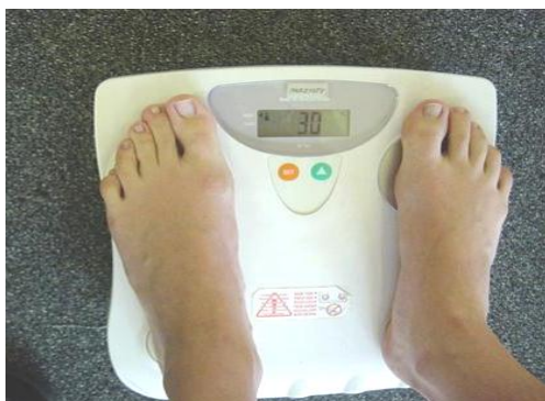
Rys 1. Pomiar masy i zawartości tkanki tłuszczowej wagą TANITA
