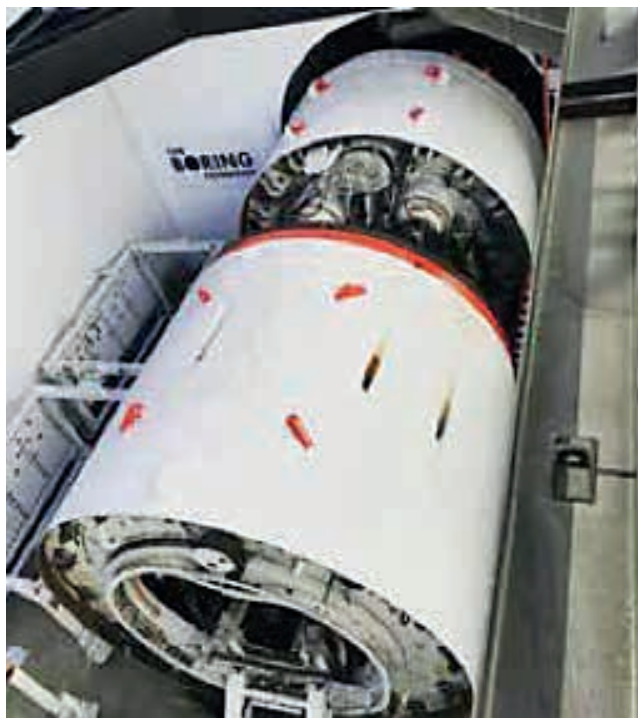
Ryc. 5. Segmenty maszyny do tunelowania firmy The Boring Company w szybie startowym [1]
