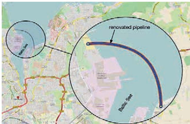
Ryc. 3. Trasa instalacji 1240-metrowej powłoki Primus Line® [1]
