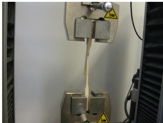
Rys. 5. Rozciąganie próbki drewna świerkowego wzdłuż włókien Fig. 5. Stretching along the fibers of sample spruce wood
