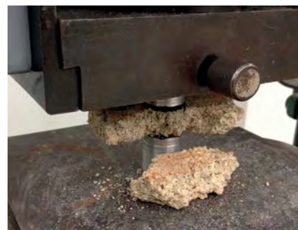
Rys. 8. Wygląd próbki zaprawy murarskiej po zniszczeniu
