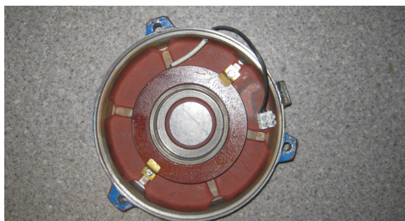
Rys. 1. Widok montażu cewki pomiarowej wraz z wyprowadzonymi zaciskami od wewnętrznej strony tarczy łożyskowej po stronie napędowej dla silnika Sg112M-4
