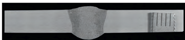
Rys. 7. Makrostruktura spawanego hybrydowo złącza doczołowego blach o grubości 5 + 5 mm
