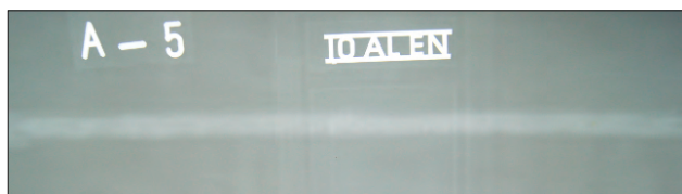
Rys. 6. Radiogram złącza doczołowego 5+5 mm wykonanego metodą HLAW
