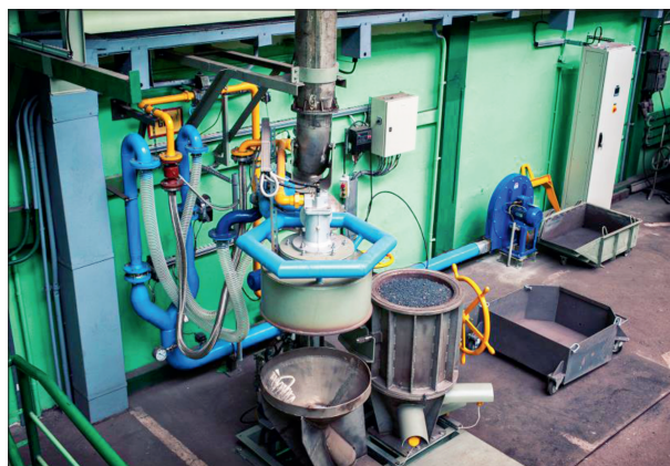
Rys. 9. Laboratoryjne stanowisko spiekania rud żelaza i odpadów
