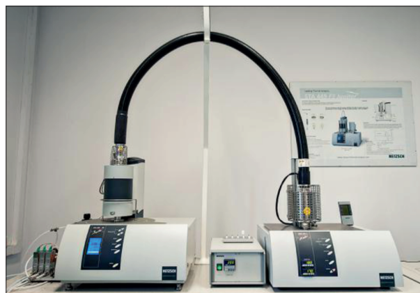
Rys. 2. Stanowisko do symultanicznej analizy termicznej TG-DTA/DSC z równoczesną analizą składu gazów QMS firmy NETZSCH (STA 449 F3 Jupiter + 403 Aëolos)
