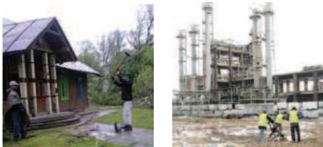
Rys. 7, 8. Pomiar sejsmiczny w celu poszukiwania podziemnych pomieszczeń (komór, tuneli) lub pozostałości po nich w obrębie stanowiska archeologicznego (po lewej) oraz pomiar georadarowy na terenie zakładów chemicznych w celu rozpoznania pozostałości starych fundamentów, niezidentyfikowanej infrastruktury oraz zbiorników paliwowych, wykonywany dla potrzeby nowej inwestycji – po prawej
