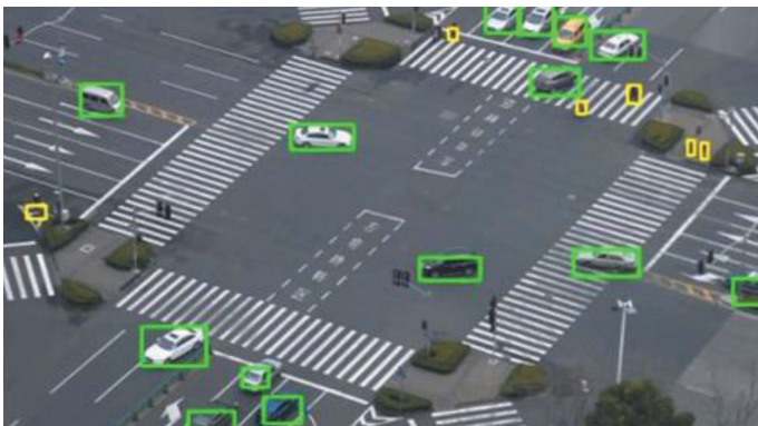
Rys. 2. Wideodetekcja z wykorzystaniem wirtualnych pól pomiarowych Źródło: http://www.fujitsu.com/cn/en/Images/figer-4_tcm144-1598334.jpg
