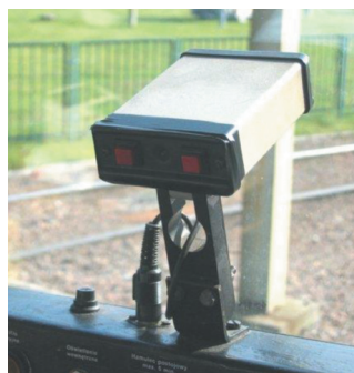
Fot. 4. Nadajnik detektora promieniowania podczerwonego Źródło: http://www.transportszynowy.pl/nadajnikd.jpg
