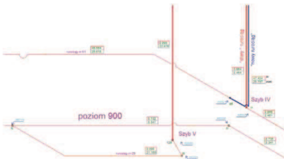
Rys. 4. Schemat sieci odmetanowania w rejonie podszybia szybu IV i szybu V, wydatek objętościowy [m 3 /min], dolny zielony prostokąt – przed regulacją, górny czerwony prostokąt – po regulacji, przy węźle – wartość podciśnienia
