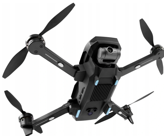
Rys. 2. Dron YUNEEC Mantis G zasilany silnikami elektrycznymi [11]
