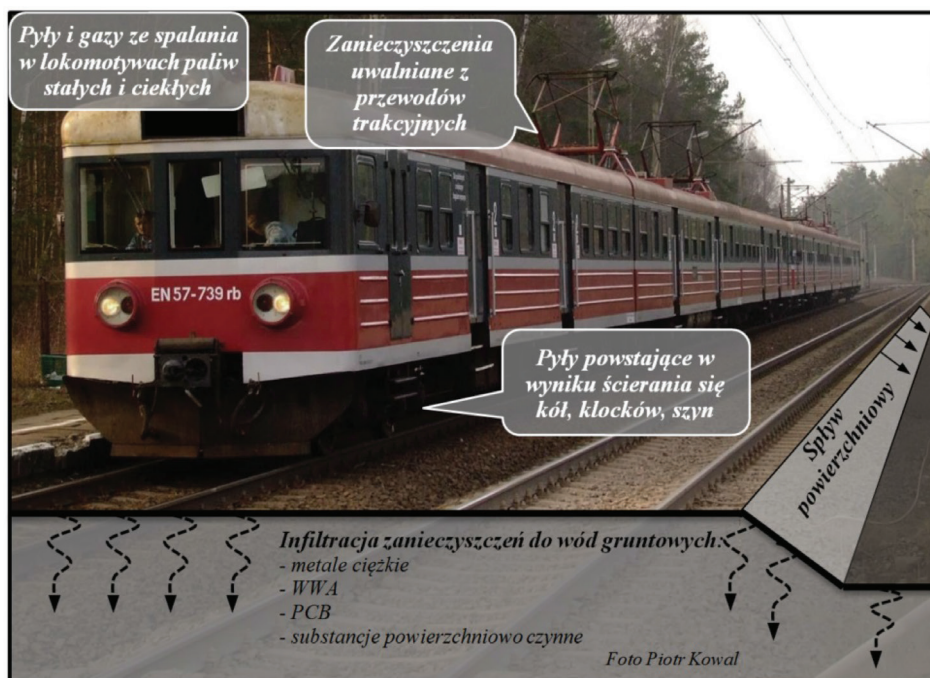
Rysunek 1. Źródła zanieczyszczeń charakterystycznych dla transportu kolejowego Figure. 1. Sources of pollution typical for railway transport
