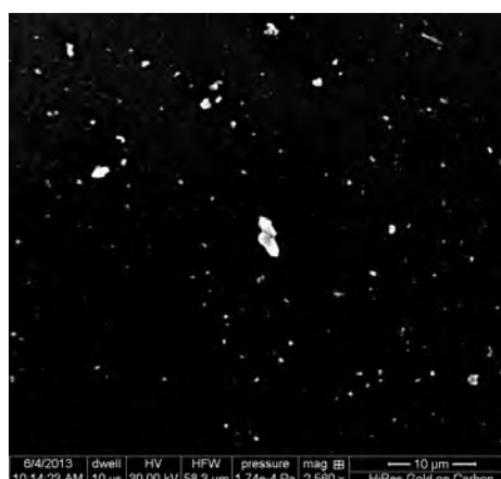
Rys. 7. Zdjęcie ze skaningowego elektronowego mikroskopu (SEM) cząstek platyny w matrycy kompozytu węglowo-platynowego z 10% wag. Pt (ST-A-Pt-10%)
