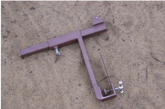
Zdjęcie uchwyty. Uchwyt posiada możliwość regulacji położenia górnego punktu odniesienia linii pionu. W górnym prawym rogu uchwyty znajduje się błoček do nawinięcia linki (konstrukcja własna administracji miar). fot. arch. własne
