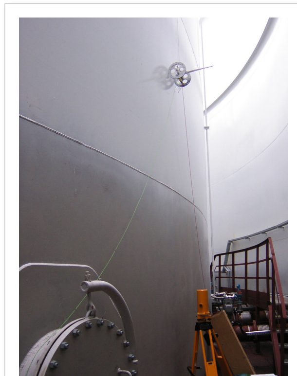
Zdjęcie pionownika optycznego będącego na wyposażeniu administracji miar. Na zdjęciu jest widoczny również wózek magnetyczny z podzielną.
