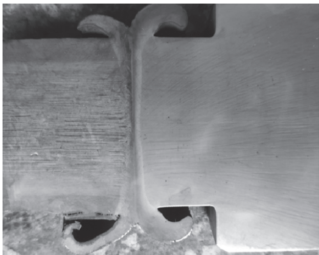
Rys. 3. Makrografia zgrzeiny wykonanej tarciowo. Trawienie wykonano odczynnikiem Adlera zgodnie z wycofaną normą PN-61/H-04502 [4] [fot. M. Ostromęcka]
