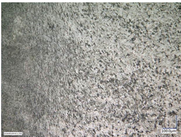
Rys. 5. Struktura ujawniona po stronie stali martenzytycznej po wytrawieniu samym odczynnikiem Adlera; z lewej strony drobnoziarnista martenzytyczna strefa cieplno-plastyczna blisko linii zgrzewania [fot. M. Ostromięcka]
