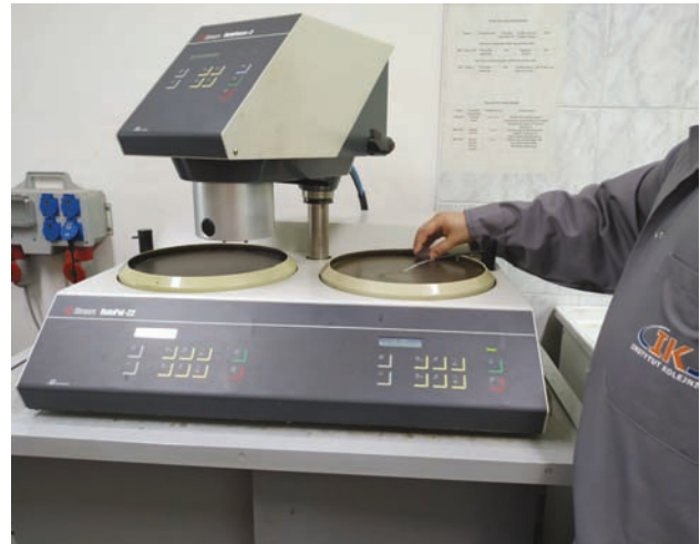
Rys. 2. Szlifowanie na szlifierko-polerce RotoPol-22 formy Struers w Laboratorium Badań Materiałów i Elementów Konstrukcji Instytutu Kolejnictwa [fot. M. Ostromięcka]
