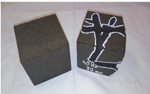
Rys. 4. Przykładowa kostka przed procesem (z lewej) i po procesie regeneracji wstępnej
