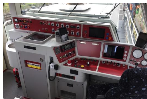
Rys. 10. Widok pulpitu sterowniczego na zmodernizowanej lokomotywie 19D
