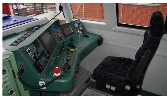
Rys. 12. Widok pulpitu sterowniczego na zmodernizowanej lokomotywie 6Di
