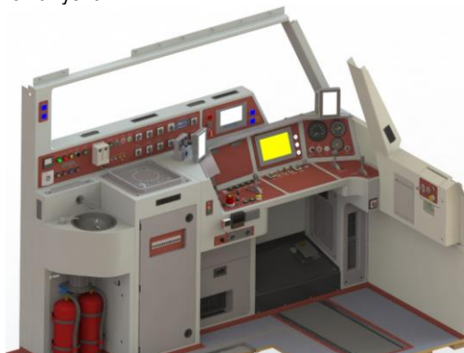
Rys. 9. Widok pulpitu sterowniczego na lokomotywie 19D – rozplanowanie głównych urządzeń i zespołów w środowisku 3D
