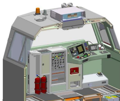
Rys. 11. Widok kabiny maszynisty z zabudowanym pulpitem sterowniczym na lokomotywie 6Di w środowisku 3D
