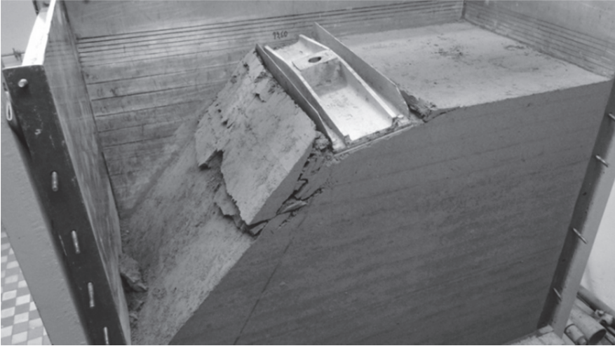
Rys. 3. Deformacje modelu nasypu z popioło-żużla na skutek utraty stateczności – skarpa o nachyleniu 45^\circ (fot. K. Olsiński)
