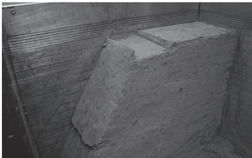
Rys. 8. Deformacje połowy modelu nasypu z piasku pylastego na skutek utraty stateczności – skarpa o nachyleniu 60^\circ (fot. P. Baran)
