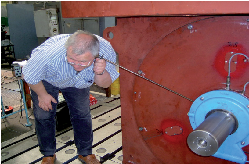
Rys. 19. Najprostszy sposób diagnozowania łożyska tocznego osłuchanie łożyska przez autora [16]
