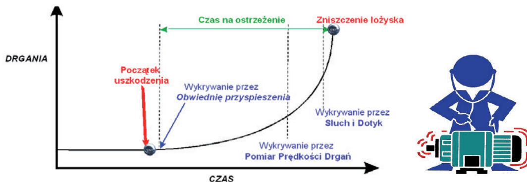
Rys. 4. Wynik pomiaru drgań węzła łożyskowego przykładowego silnika w napędzie przemysłowym, idea diagnostyki drganiowej stanu technicznego łożyska tocznego w silniku [13, 14]
