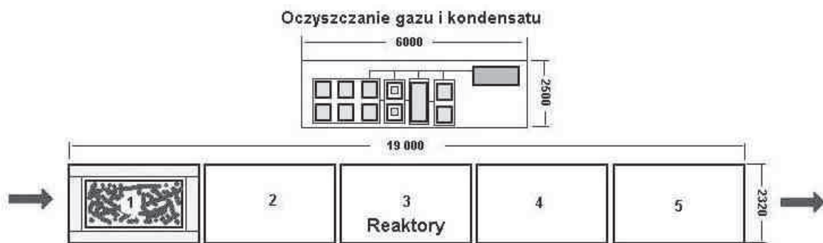
Ryc. 6. Schemat blokowy instalacji pirolizy biomasy odpadowej dla wydajności wsadu 700 t/rok s.m.
