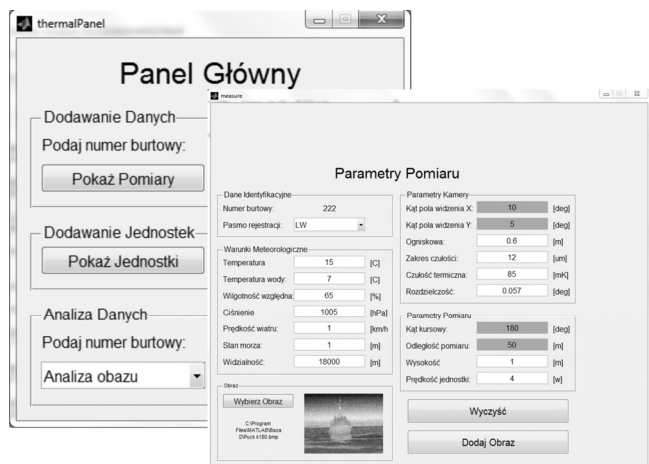
Rys. 3. Opis warunków pomiaru sygnatury termicznej Fig. 3. Conditions of thermal signature measurement
