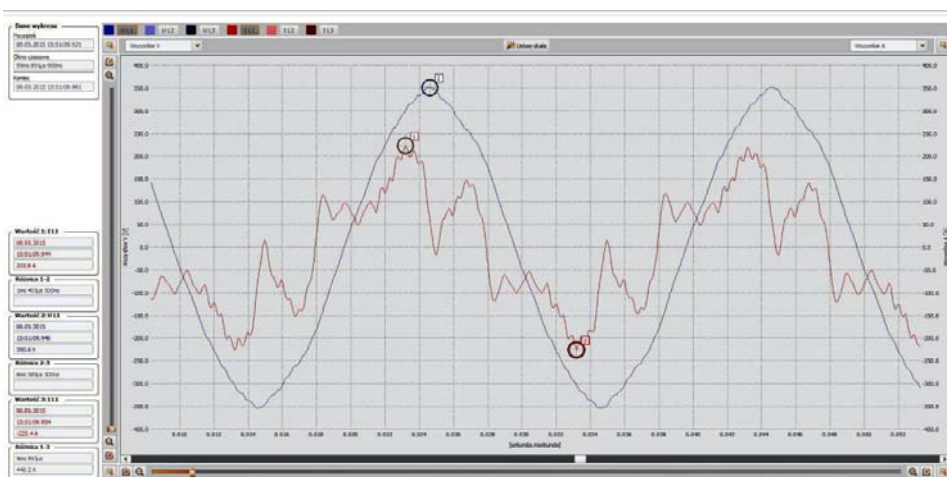
Rys. 5. Przebieg oscyloskopowy prądu i napięcia
